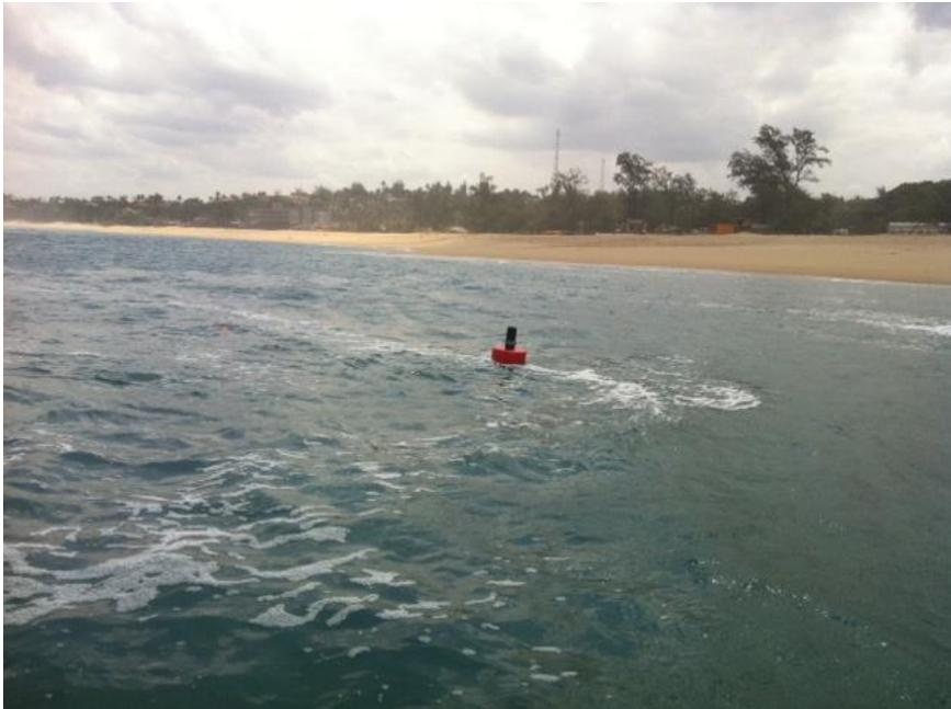
**Figura 3:** acelerómetro montado numa bóia flutuado e ancorado na praia.
