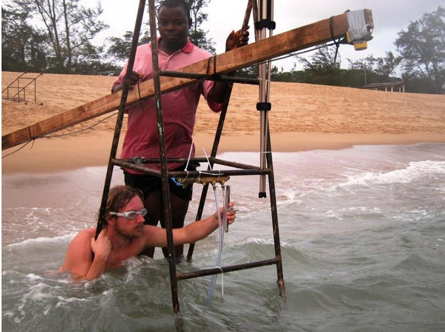
**Figura 4:** Altímetro ultra sónico montado no barrote e virado para a superfície de água e tubos plásticos ligados num sistema de vasos comunicantes.
